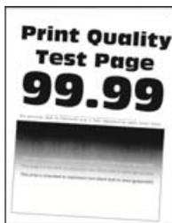
**Remarque :** Avant de résoudre le problème, imprimez les pages de test de qualité d'impression. A partir du panneau de commande, accédez à **Paramètres > Dépannage > Pages de test de qualité d'impression**. Pour les modèles d'imprimante sans écran tactile, appuyez sur
